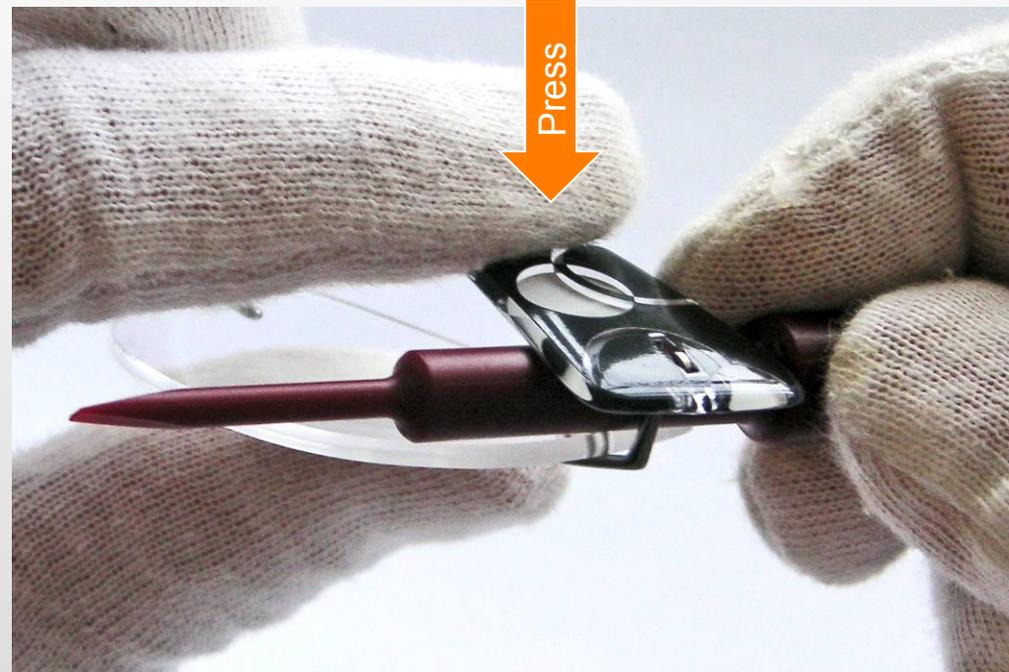
1. Coloque a ferramenta de desmontagem (AC 336) entre a lente a a haste
