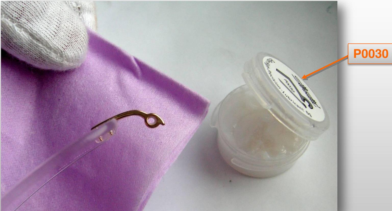
Lubrifique o interior do gancho da charneira com o lubrificante de alta precisão Teflon.
