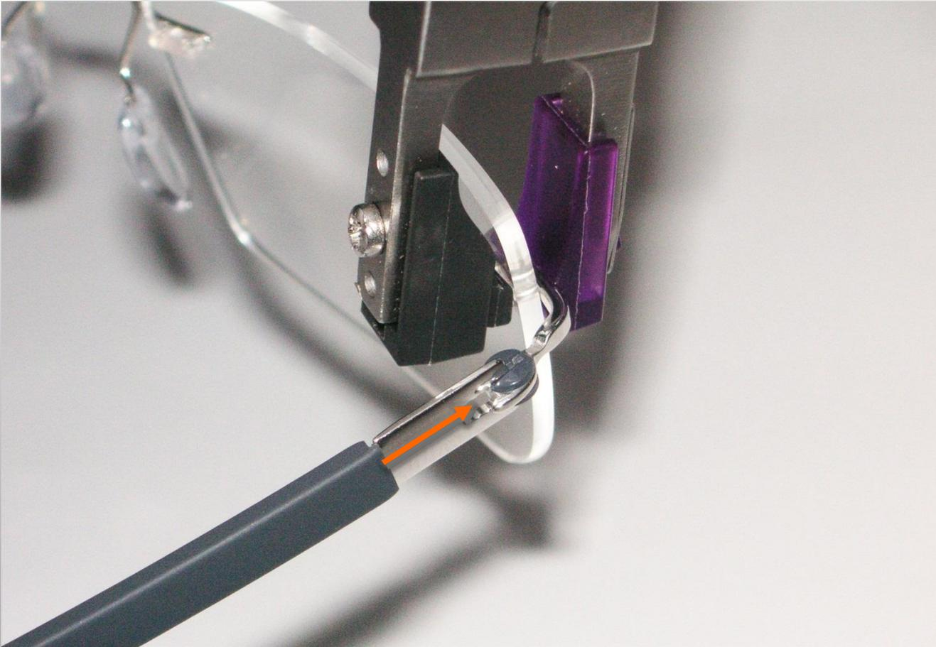
Coloque a haste exatamente no orifício dos cilindros e empurre cuidadosamente até fazer ao fim.
