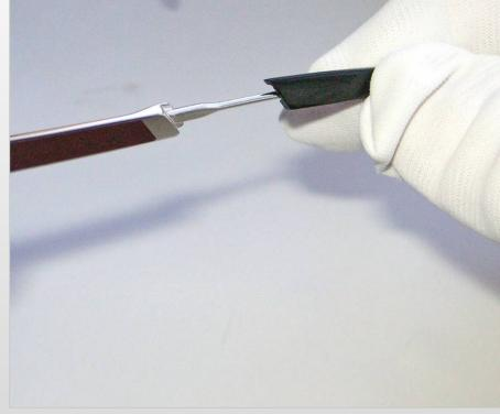
1. Solte a cola dentro do terminal, pressionando a haste e usando o alicate.
