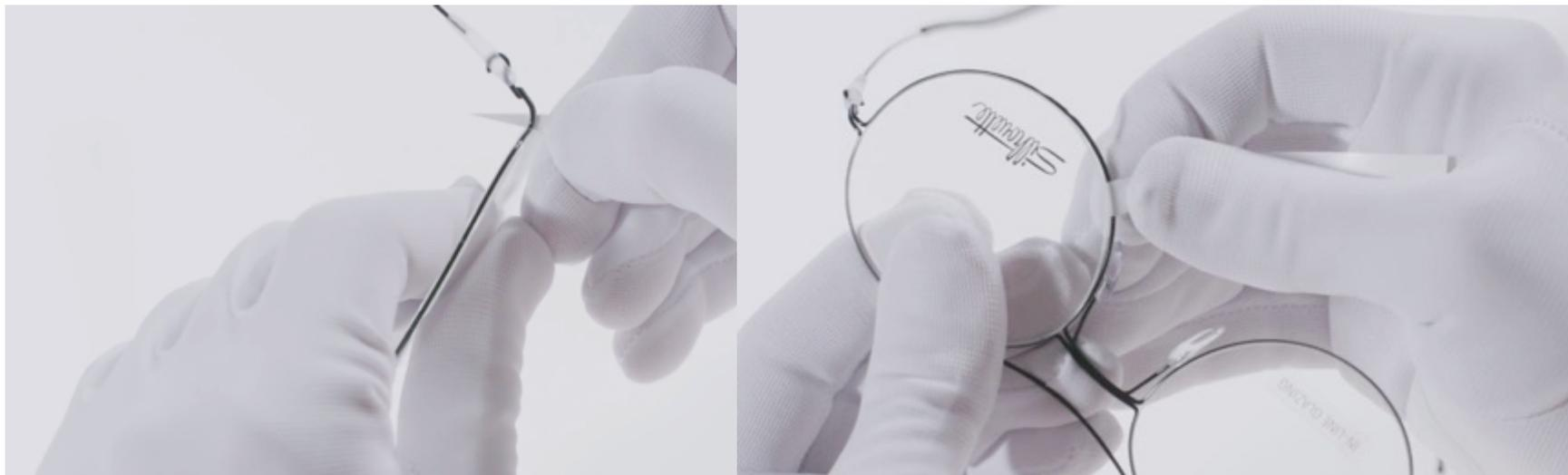
1. Insira a ferramenta de montagem entre as lentes e armação na curva temporal e vá deslizando para a zona inferior da armação.
