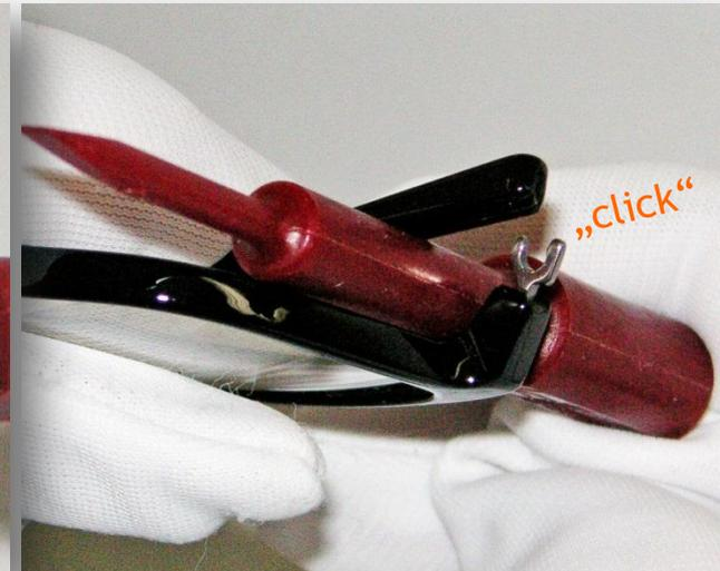
1. Coloque a ferramenta de desmontagem na charneira para que não se mova.
