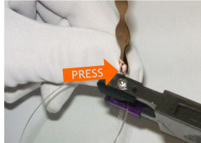
1. Segure a zona de fixação da lente firmemente com o alicate de montagem.
