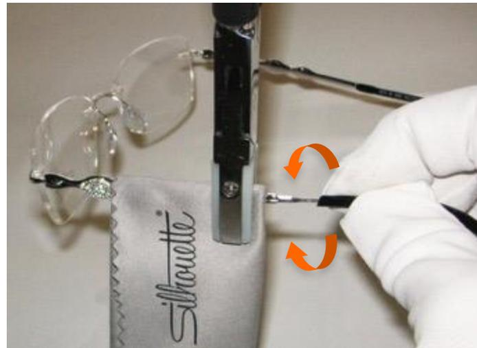
2. Proteja a haste de metal com um pano e segure-o firmemente com o alicate
