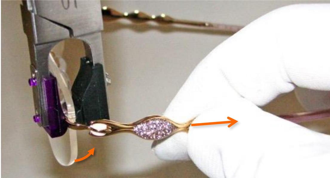
1. Segure a zona de fixação da lente firmemente com um alicate de montagem.
