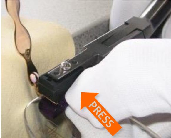
1. Segure a zona de fixação da lente firmemente com o alicate de montagem.
