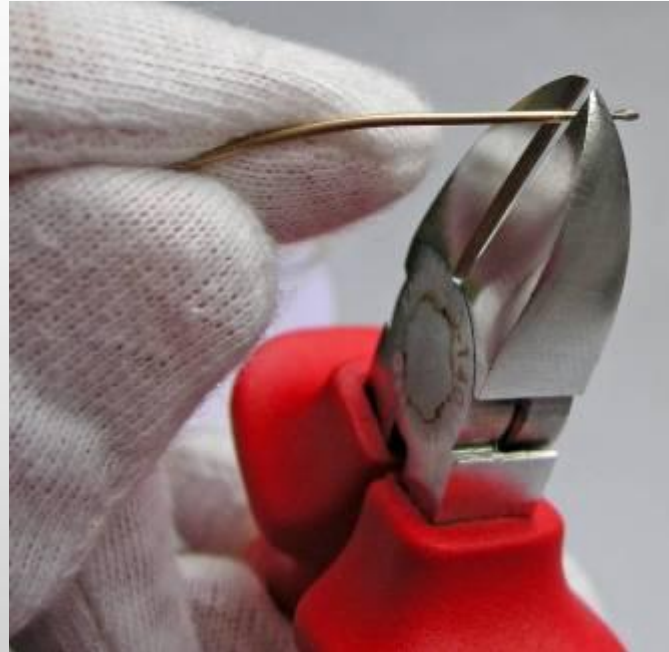
2. Corte o titânio com o comprimento desejado com o alicate apropriado.
