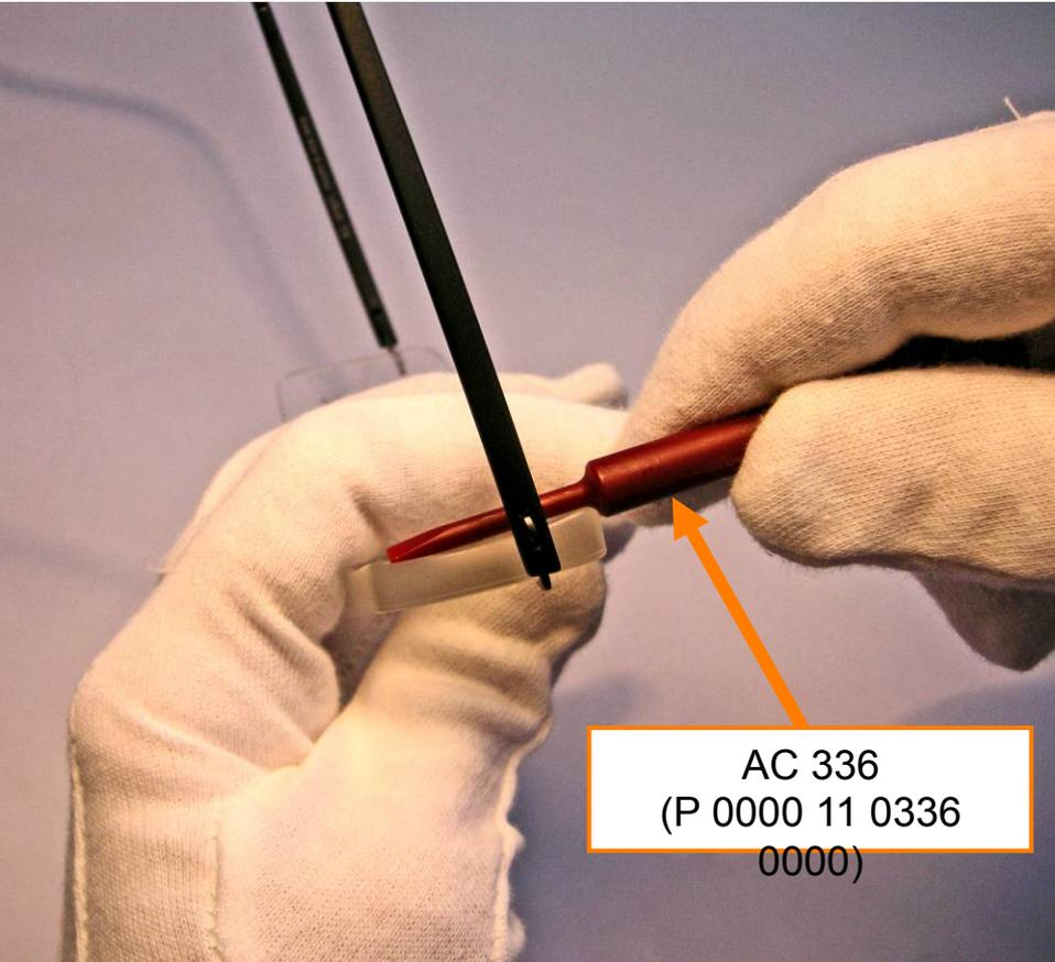
1. Use uma ferramenta de desmontagem. Coloque-o o mais próximo do interior da charneira.
