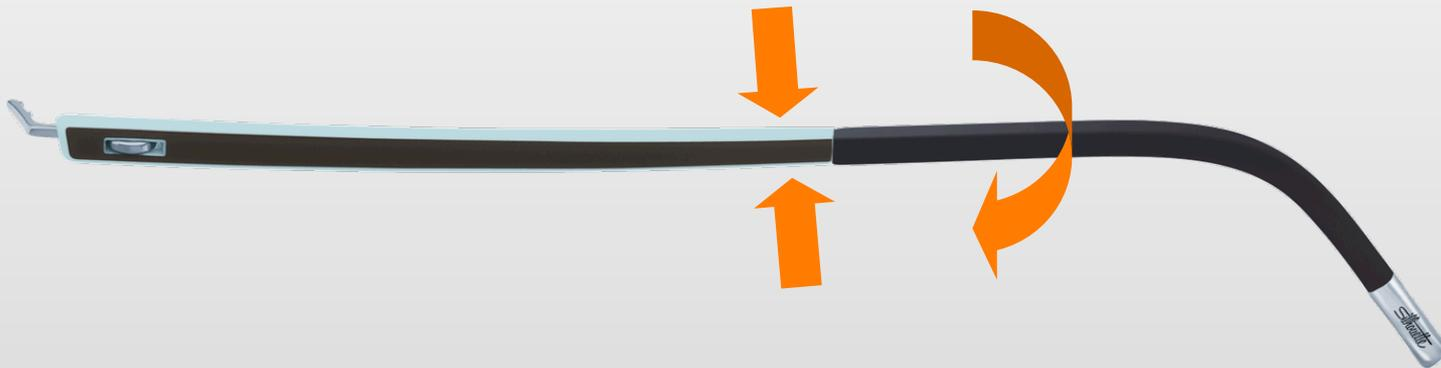
Segure a haste firmemente enquanto vai girando o terminal, até que a cola deste se solte. Seguidamente é só retirar o terminal, que sairá facilmente.
