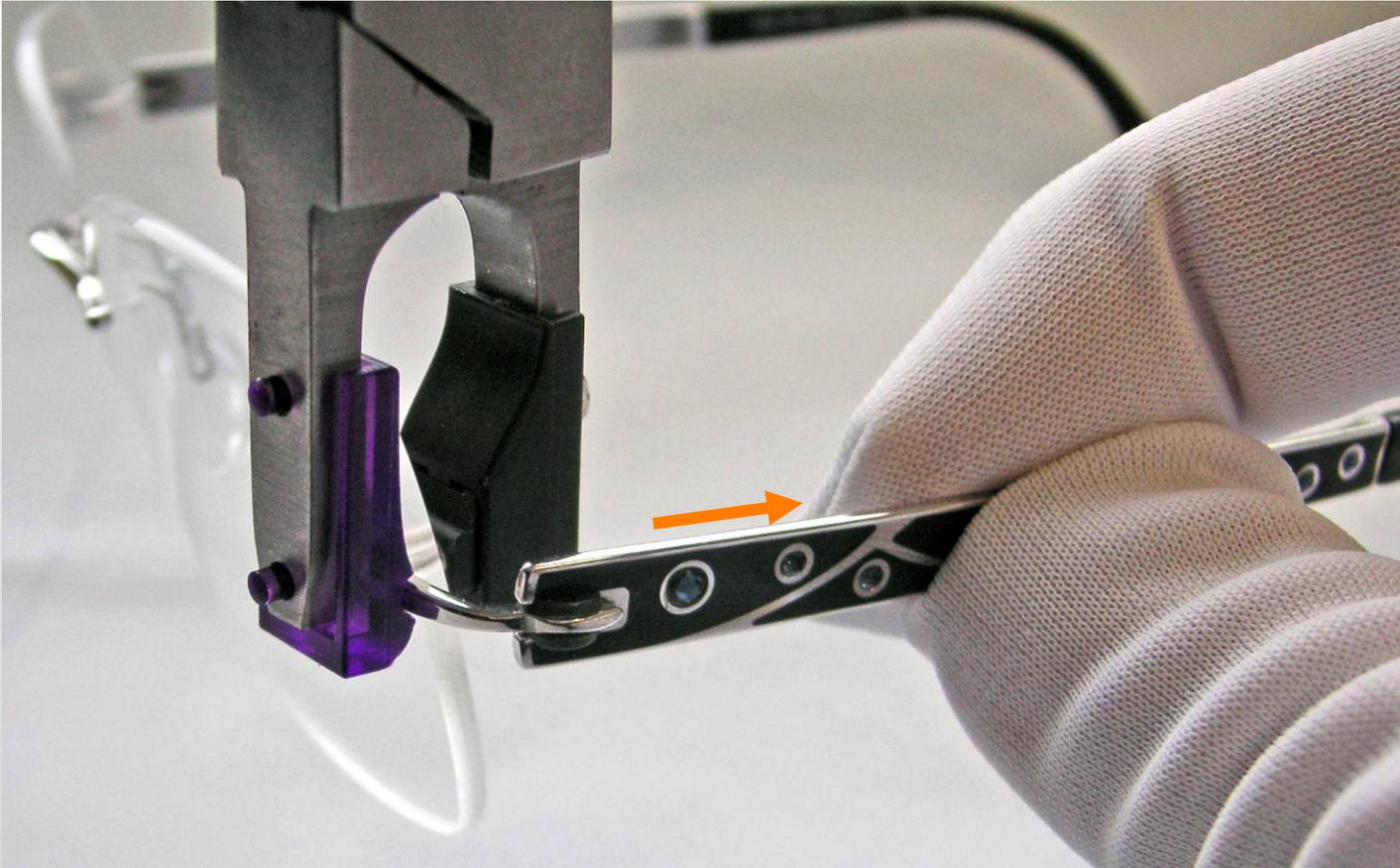
1. Segure a parte lateral da armação com um alicate.
