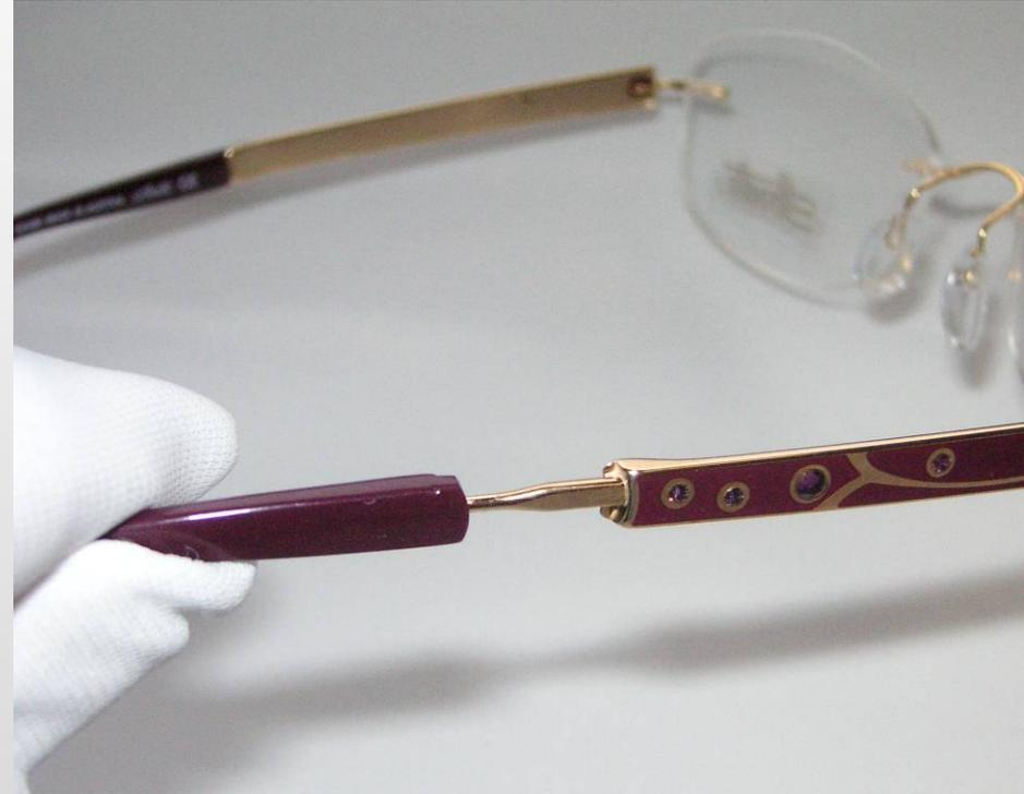
1. Solte a cola dentro do terminal, 2. Retire o terminal. pressionando a haste e usando o alicate, aplicando movimentos rotativos
