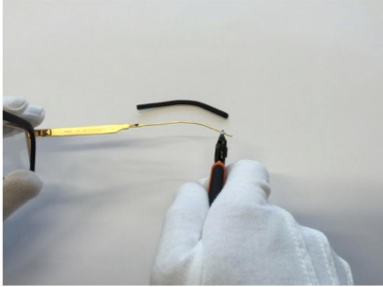
Depois de quebrar a cola com um alicate, encurte a haste com uma ferramenta de corte
